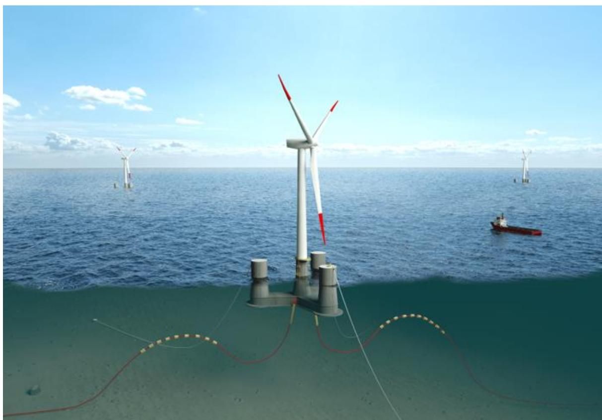
**L'ABS a accordé l'Approval in Principle (AiP<sup>1</sup>) au flotteur semi-submersible en béton OO-STAR de Bouygues Travaux Publics, filiale de Bouygues Construction, capable de supporter des éoliennes de plus de 20 MW dans des environnements offshore difficiles. Ce résultat est une première étape dans son déploiement sur le marché**
